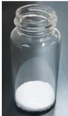
写真-4 下水灰から回収したリン酸塩化合物
